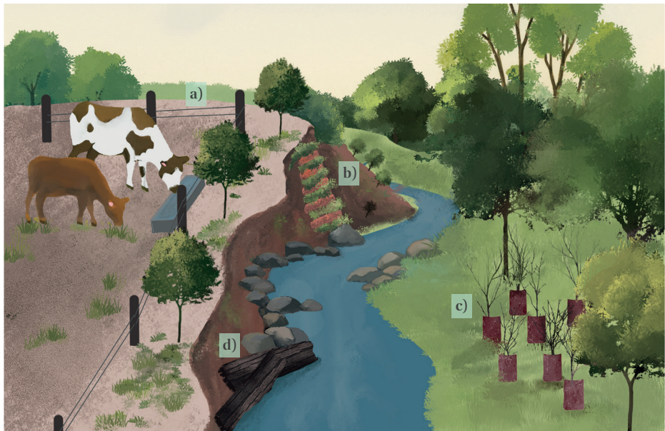
Figura 54. Resumen de prácticas de restauración de riberas. a) Práctica sobre control de acceso al cauce. b) Ejemplo de práctica de estabilización de riberas. c) Prácticas de reforestación y revegetación. d) Prácticas de recuperación del hábitat acuático.
